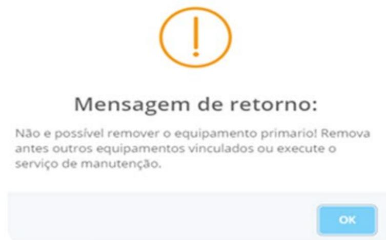
No caso do serviço de retirada, quando o veículo tiver mais de um equipamento vinculado não será possível fazer a retirada do equipamento primário, caso seja realmente necessário fazer a retirada opte por fazer a retirada de todos os outros equipamentos antes ou realize o serviço de manutenção.
